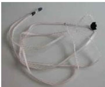
ラジオに付属もしくは、別途購入したT型FMアンテナをT字型にして壁に張ることでフィーダー線がアンテナとなります。T型FMアンテナはホームセンターや一部の電気店でも販売しています。
